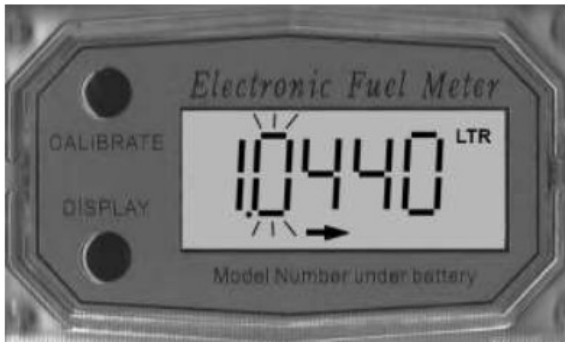
Obr. 6 Změna hodnoty kalibračního faktoru.
