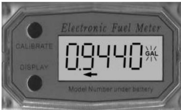
Obr. 3 Změna měrné jednotky.
