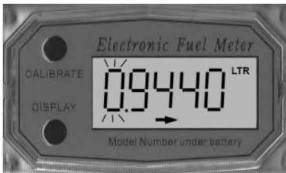
Obr. 5 Zobrazení kalibračního faktoru.
